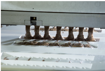
מימין: השוקולדה הנוזלית במערכת הערבוב משמאל: שפיכה למערכת היציקה וחלוקה לטבלאות
