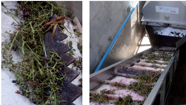
מסוע המוציא את השדרות מסוף התוף, משמאל: שדרות האשכולות על המסוע
