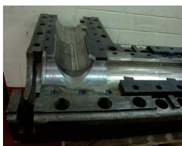
מימין: שני כיווני הסחיטה, בתמונה מימין לשמאל ומרחוק לקרוב ומשמאל מועברת המסה הסחוטה למסחטה הבאה (מכשיר מפורק).
