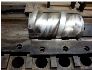
מימין: חלק מקיר המסחטה. בין הפסים הדקים יכולים לצאת טיפות השמן הנסחט משמאל: חלק מהבורג הסוחט מונח בתוך צנור הסחיטה
