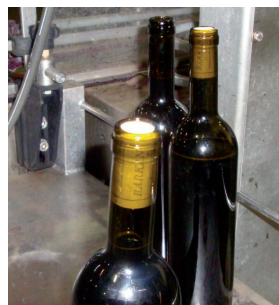
מימין : שני בקבוקים לאחר הכנסת הפקק. במרכז : פקק רגיל מונח של ראש בקבוק. משמאל : מכסה חיצוני שעל הפקק.
