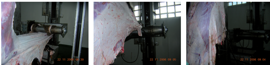
תמונה מימין לשמאל התחלת ההפשטה בסכין, תלייה לגלגל מיכאני, המושך את העור, העור מתקלף.
